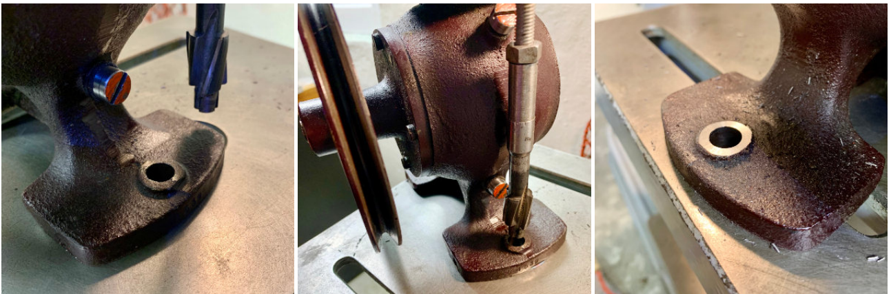
Het ruwe gietwerk vlak gefreesd voor een optimale bevestiging met sluitring en moer. 5 sept. 2025.
