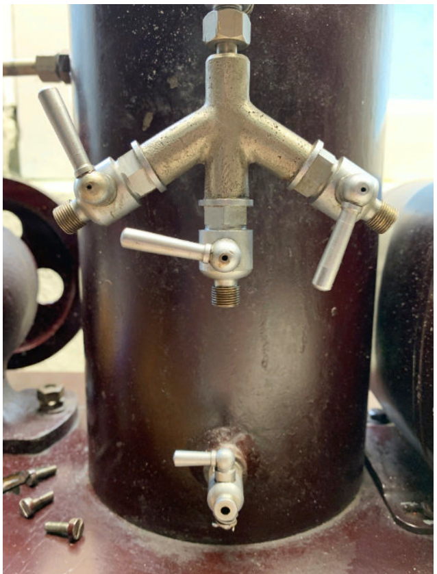
Foto van de voet die helemaal verteerd en ingezakt is. 1 sept. 2025 Compressormotor. Het kijkvenster verwijderd en de harde pakking nog tegen het gietijzer. Deze pakking verwijderd en nieuwe pakkingen gemaakt. Foto's 1 sept. 2025. Rechts: de kranen gangbaar en schoon gemaakt. Onderaan de ontluuchtingskraan.
