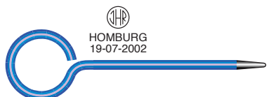
Tekening montagepen van staaldraad voor montage zuiger / afdichtring in de cilinder
