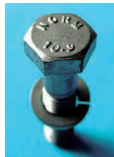
Foto bout M8 x 35 DIN 931 10.9 veerring M8 DIN 127B
