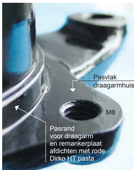
Foto lagerhuis - pasvlak in draagarm
