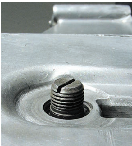
Foto detail scharnier-as (10) in het differentieelhuis rechts aanzicht van onderkant
