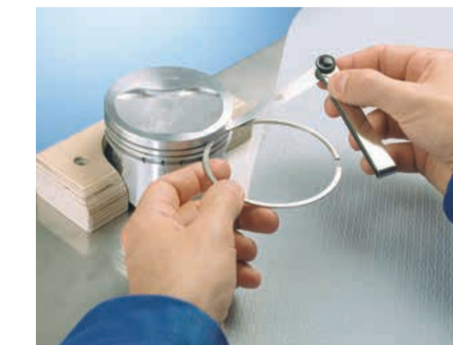
Messung der Kolbenringnuten mit einer Fühlerlehre. KOLBENSCHMIDT Artikel-Nr. 50 009 824
